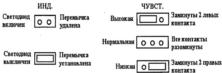
Рис. 3. Клеммы подключения
